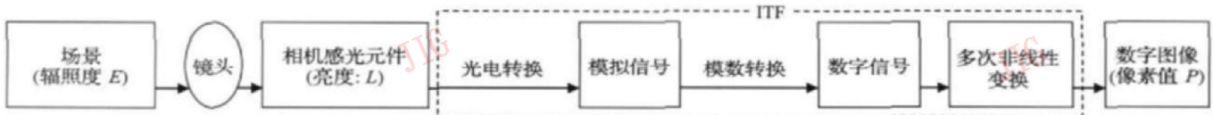
图 3 数码相机成像过程
